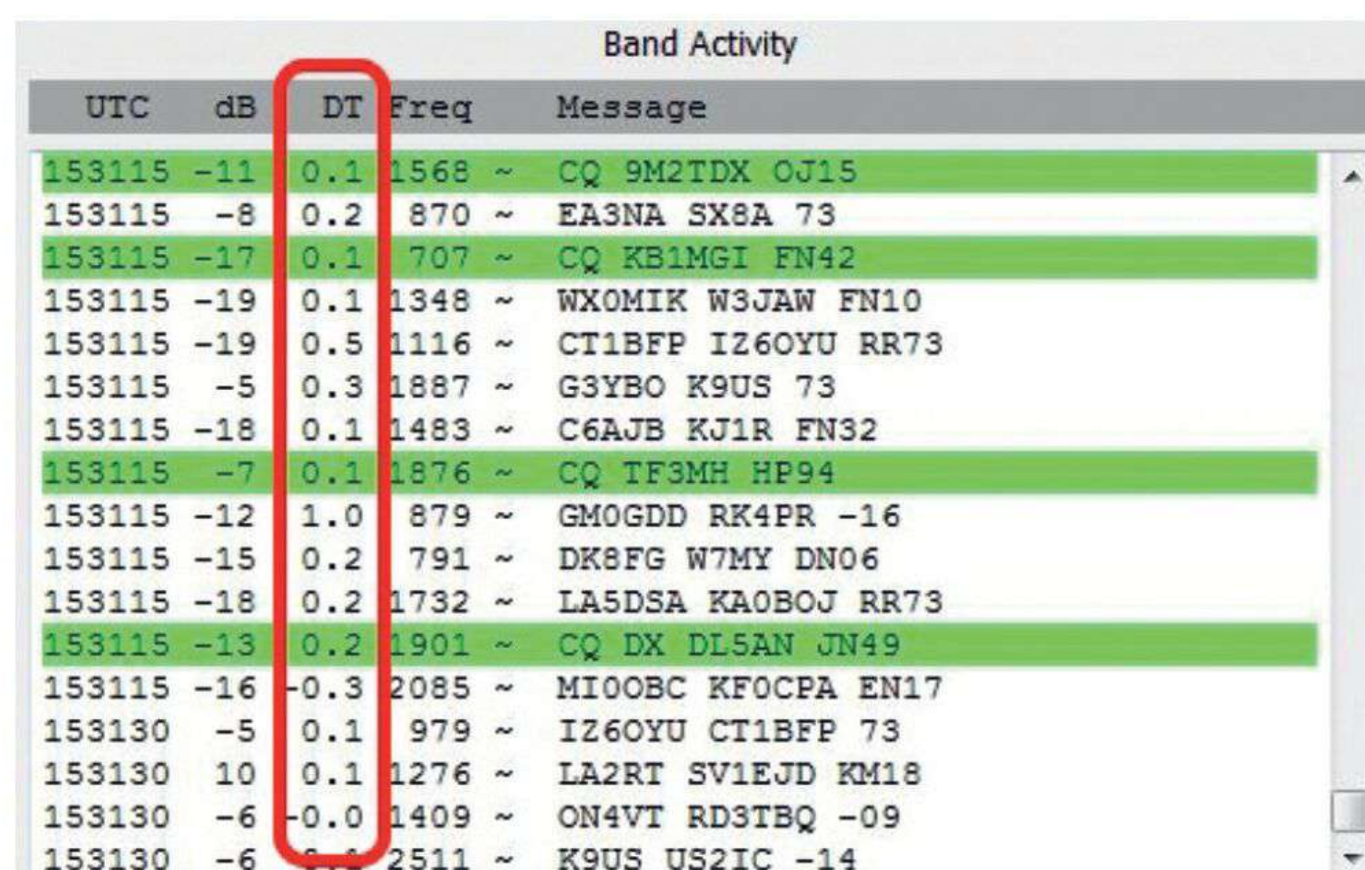
Bild 2: Die Spalte DT zeigt die Zeitabweichung. Aktualisieren Sie die Zeitsynchronisation der PC-Uhr, wenn bei mehreren Stationen höhere Werte als 1 Sekunde rot angezeigt werden.
