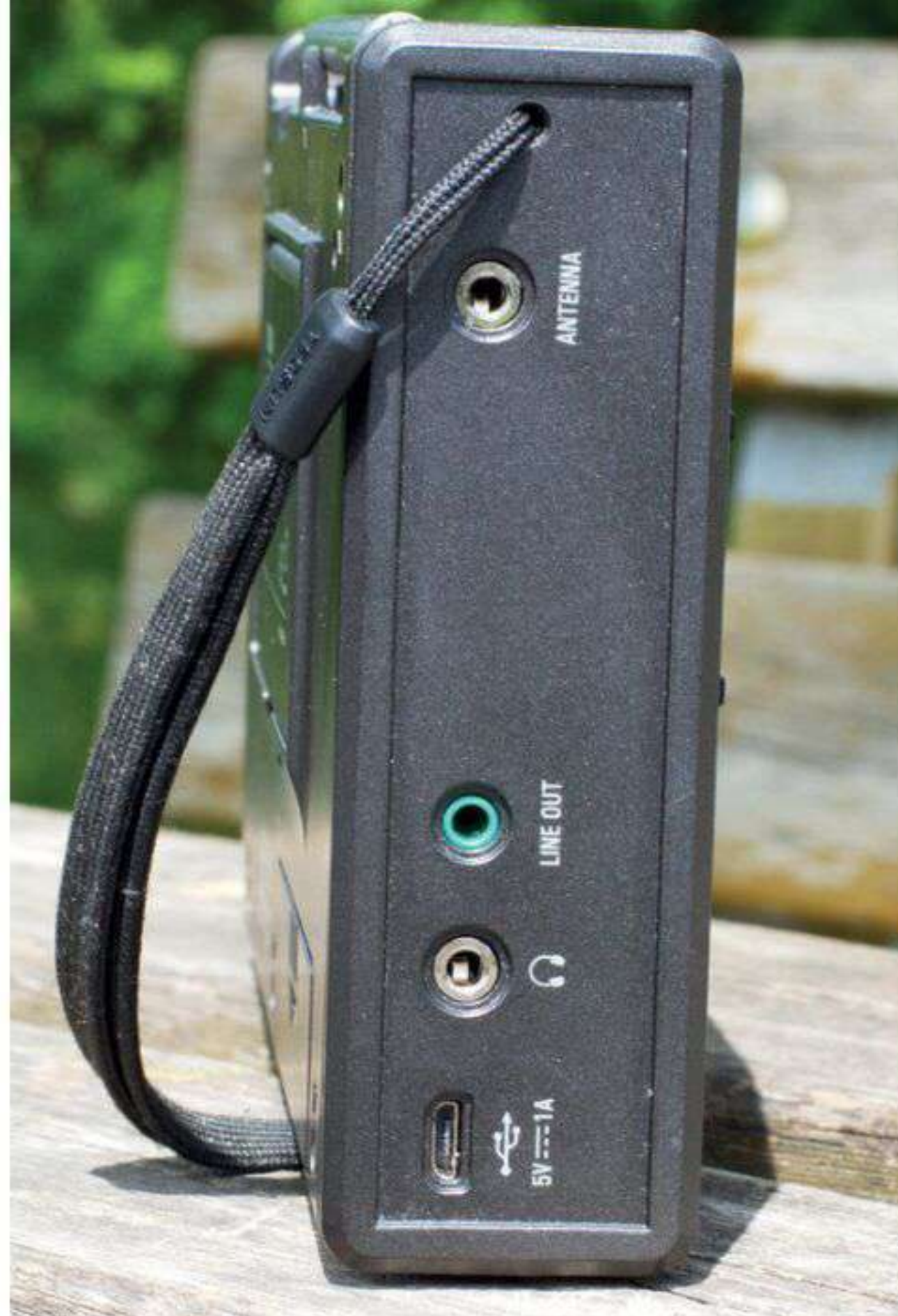
Bild 3: Blick auf die linke Schmalseite: Antenneneingang (alle Bänder), Ausgänge für Line-Out und Kopfhörer, USB-Buchse zum Laden des Akkus und für den Zugriff auf die SD-Karte.
