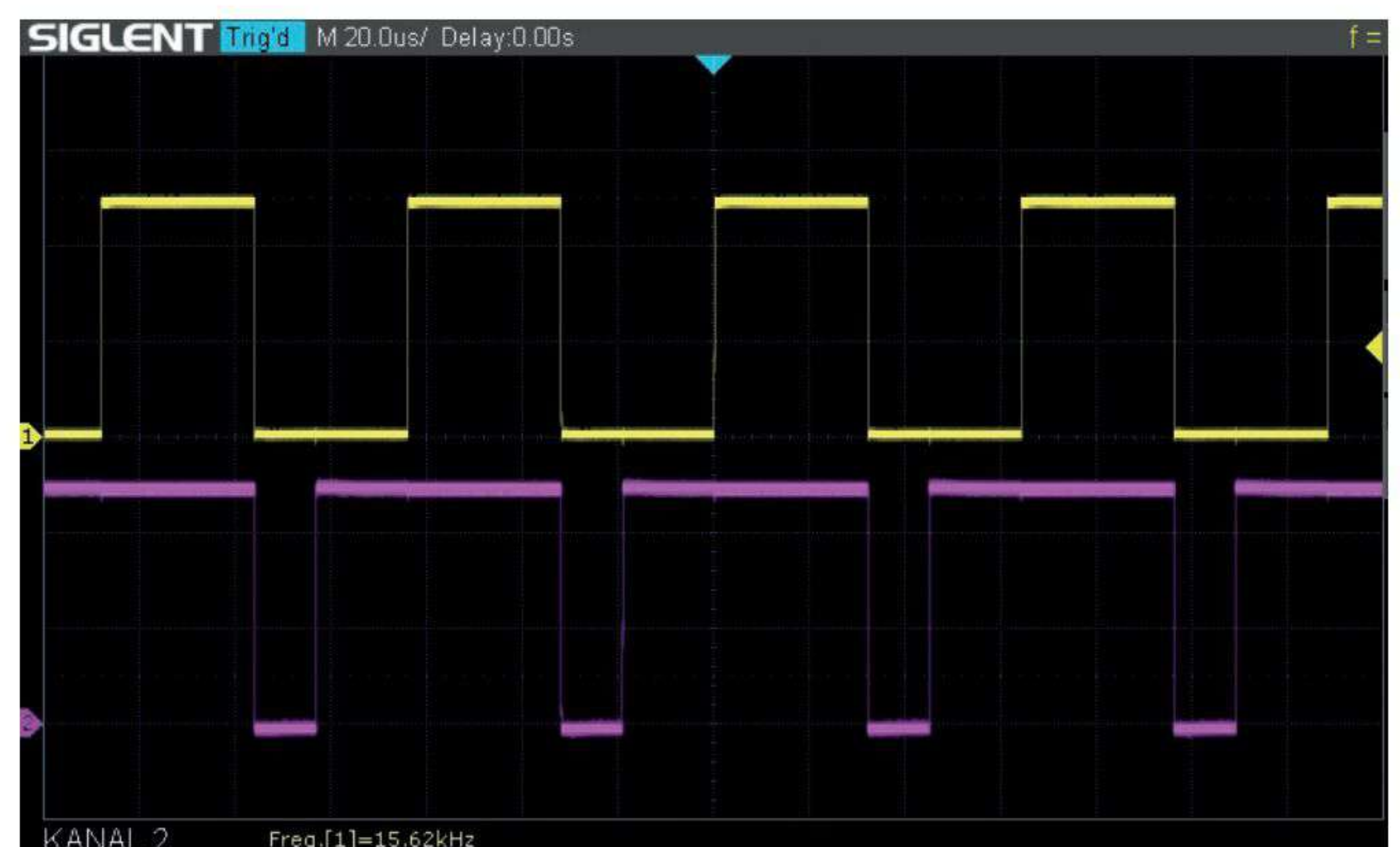
Bild 10: Ausgabe der PWM über OC1A und OC1B. Oben die 50%-Tastung, darunter das Signal von OC1B mit einem Tastverhältnis von 80 Prozent.
