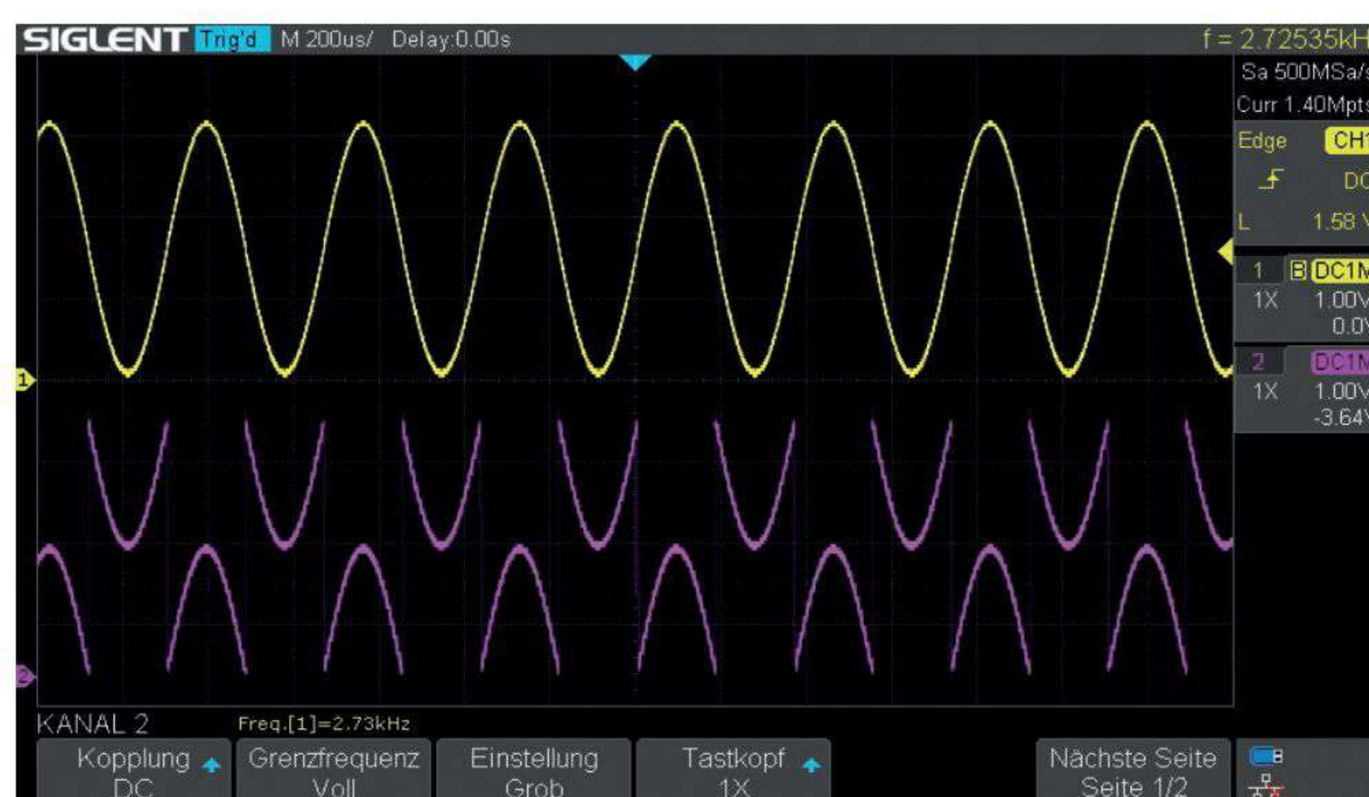
Bild 1: Ausgabe des Sinussignals mit 2700 Hz, oben das Nutzsignal (GPIO26/DAC2), unten das auf GPIO25 ausgegebene Signal.
