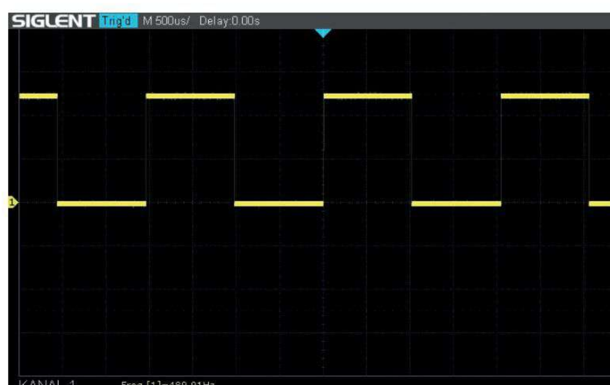
Bild 2: Der Arduino UNO erzeugt ein PWM-Signal, Tastverhältnis 50%, 1ms High-Pegel und 1ms Low-Pegel.
